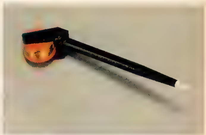
Bild 10. Der Fädelstift erleichtert die Verdrahtung beim Aufbau der Schaltung
